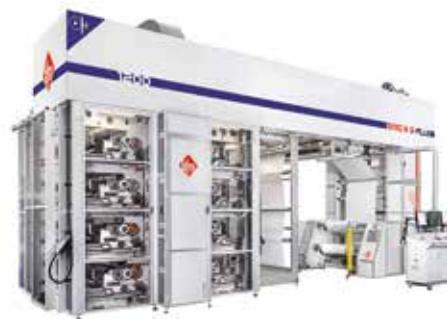
sta linea può anche essere dotata di trattamento corona (rinfrescante o totale) guidafilm automatici e micro-perforatori.
