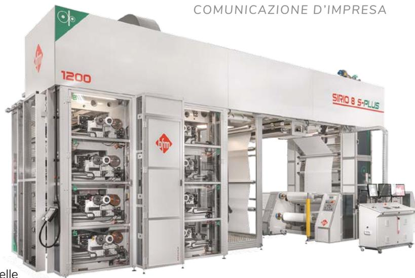
compattezza dimensionale e la giusta precisione di stampa, mentre gli azionamenti digitali IndraDrive M assicurano il costante sincronismo tra i diversi elementi stampa, e il conseguente mantenimento del registro sia ad elevate velocità sia in fase di accelerazione e decelerazione.
